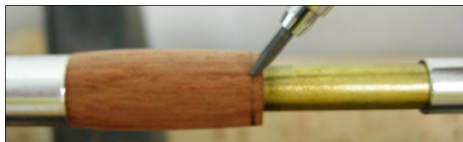
安裝橡膠管的部份, 多的木管以分離車刀車削掉.
